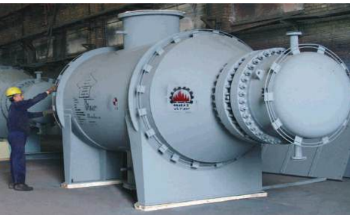
▲ مبدل‌های حرارتی پروژه NGL (SLKL)
